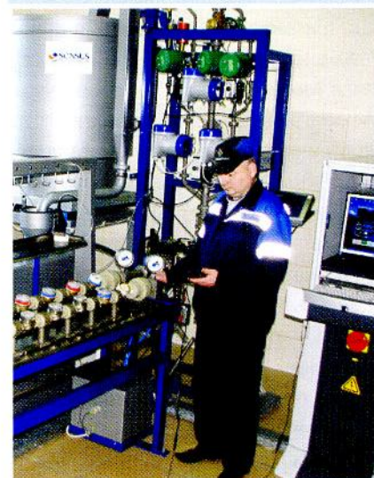
Проливная станция водомерной мастерской для испытания водомеров
